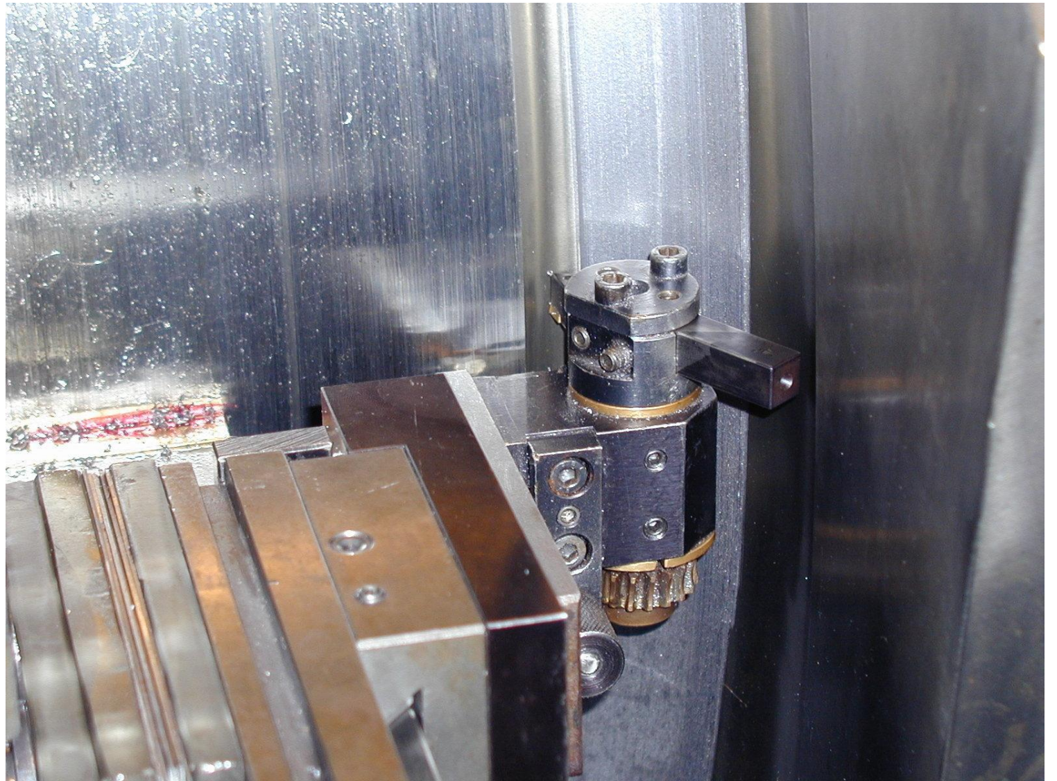
Re machining fillet radii
